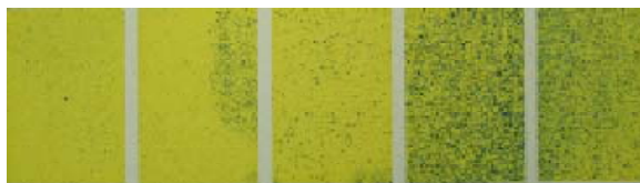
図2 水道水を15L/10a 散布したときの感水紙付着状況 注) 平均付着割合 5.5 %
