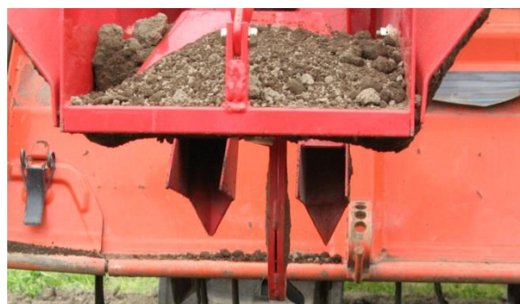
A区：作溝チゼル・両側側条施肥
