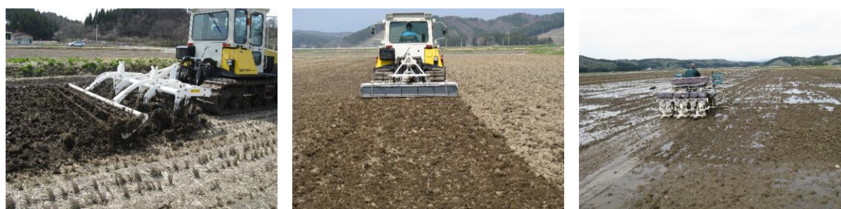
図2-1 無代かき湛水直播の播種床造成と播種の状況（左 スタブルカルチによる耕起作業，中央 縦軸駆動ハローによる砕土・整地作業，右 高精度湛水直播機による播種の状況）
