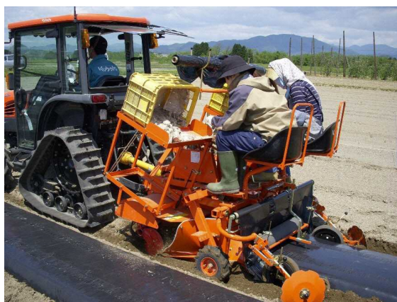
図 3-5 ヤマノイモ用 2 条植半自動移植機(市販機: TFP-200M 型)
