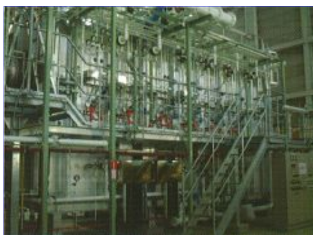
炭化炉 （外熱式ロータリー）
