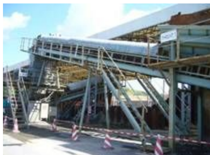
造成地に盛土の品質確保のため設置したプラントと造成の状況
