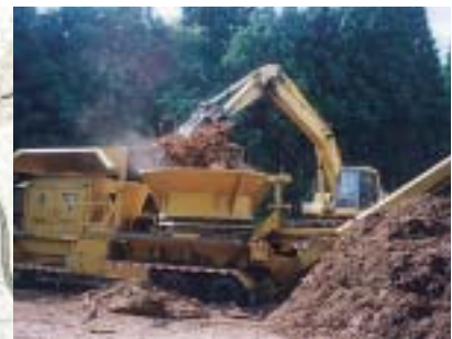
現地破碎処理によるチップ化状況
