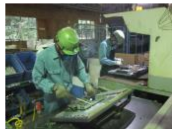
薄型テレビ解体の様子
