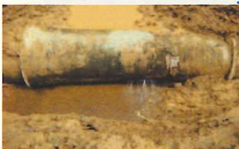
国営農地開発 須川地区(一関市)のパイプライン破損
