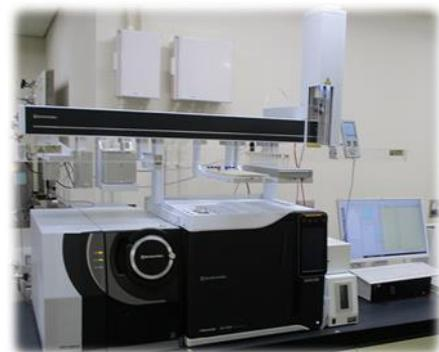
ガスクロマトグラフタンデム質量分析計 (GC-MS/MS)
