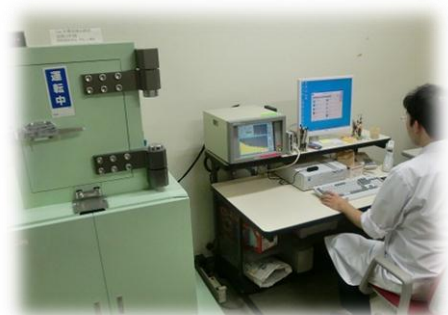
食品に含まれる放射能の測定 (ゲルマニウム半導体検出器による)
