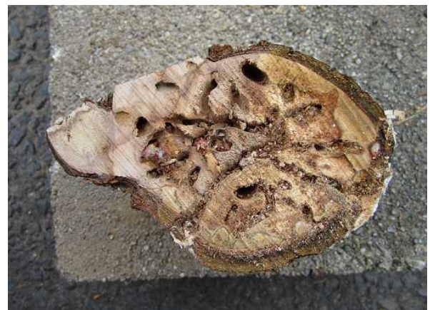
図-4 穿孔食害跡(断面)
