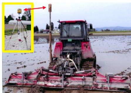
レーザー均平機による均平作業
