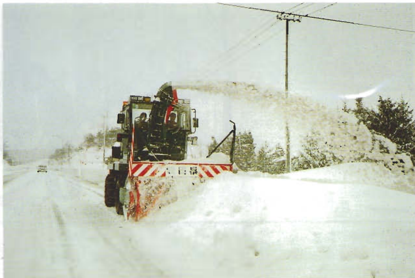
機械除雪（ロータリ除雪車による拡幅除雪）
