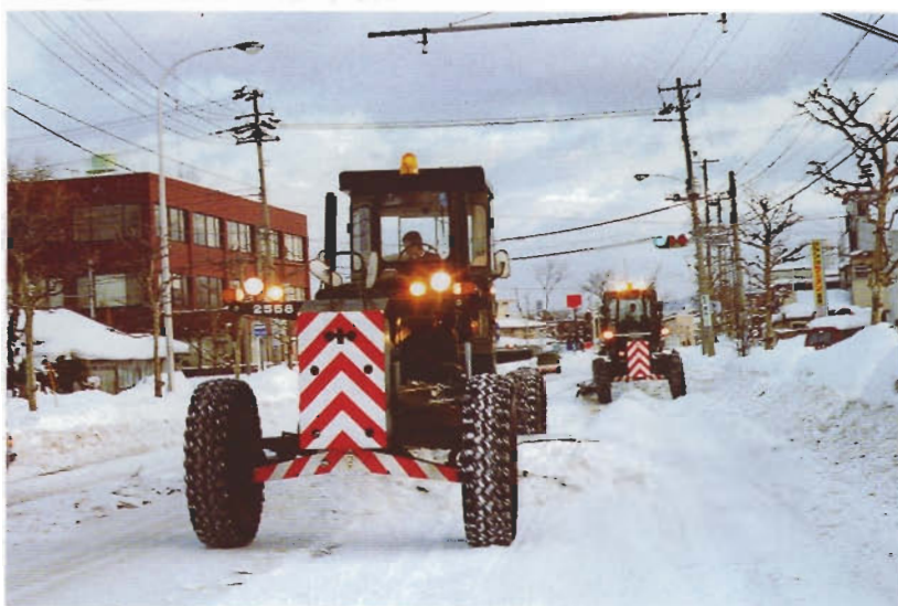
機械除雪（除雪グレーダによる路面整正）作業
