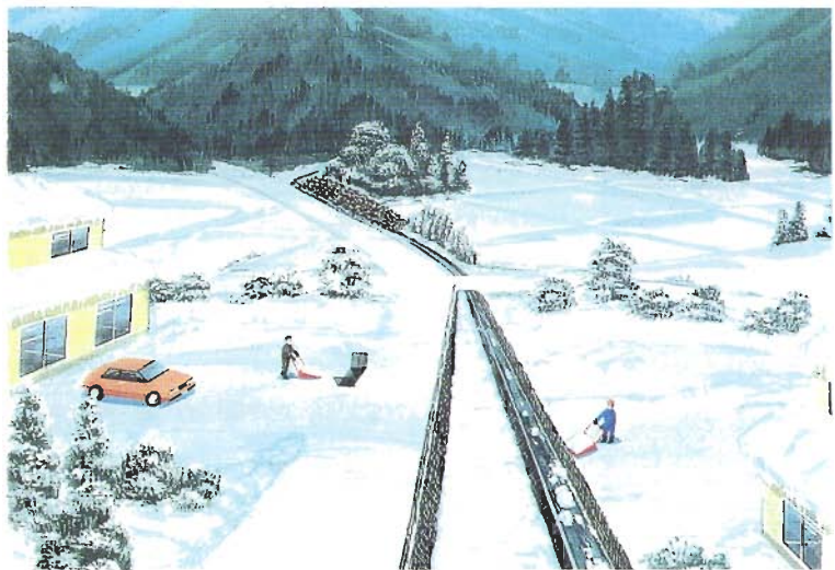
流雪機能を持たせ、雪対策に配慮した流路工、荒沢川・東成瀬村（イメージ図）
