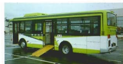
ノンステップ・スロープ付車両 (地方バス補助事業で導入)
