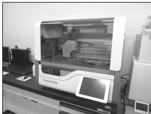
自動核酸精製装置を増設するのに半年待ち 内部に見えるマジックハンドが自動で動く
