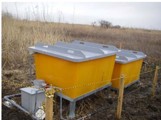
図 フィールドに設置したリン除去・回収装置
