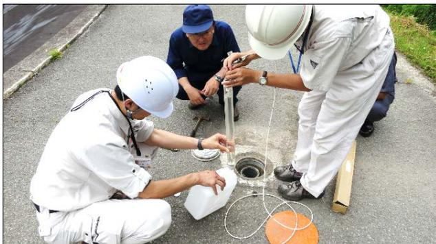
図13 地下水の採取（災害廃棄物）
