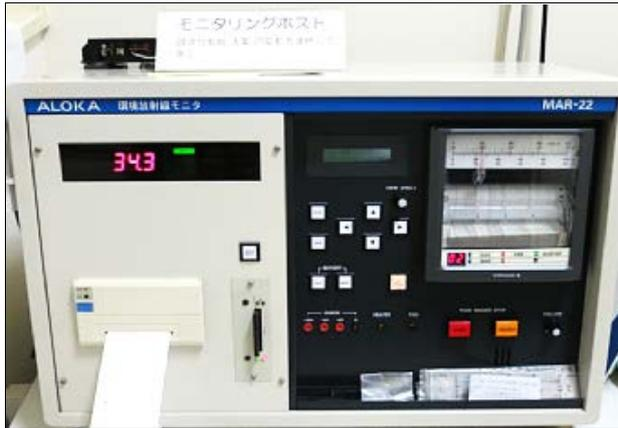
図2 モニタリングポスト計測器
