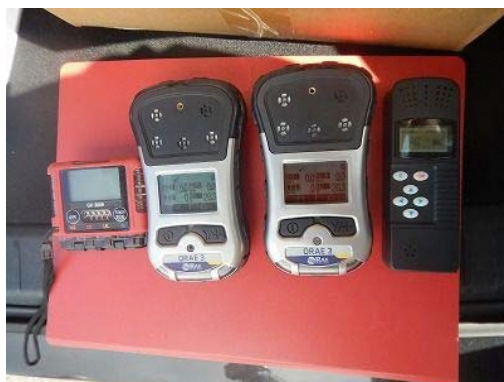
写真 4.2.1 ガス検知器（左：携帯型ガス検知器、右：設置型ガス検知器（御嶽山））
