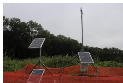
無線 LAN による伝送機器 (株) エコモット ( https://www.genbaroid.jp/product/long-distance-wireless-lan.html )
