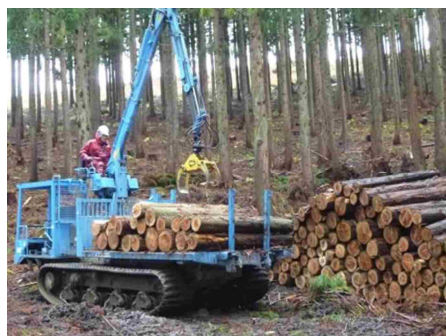
フォワーダ作業（積込・搬出）
