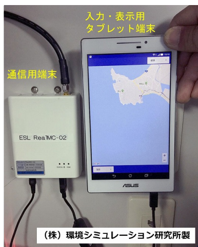
図1 漁船に設置したリアルタイム情報収集のための機材
