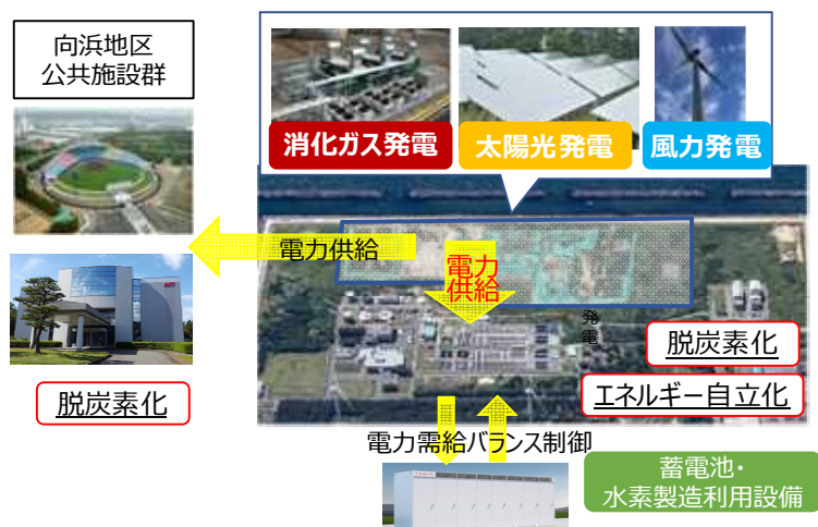
図9 秋田臨海処理センターリノベーション計画の概要（エネルギー供給拠点化）
