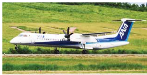
ANA・ORC【DHC8-Q400】 全長：32.8m 全幅：28.4m 全高：8.3m 座席数：74席 主な運航路線：大阪伊丹線・札幌新千歳線・名古屋中部線
