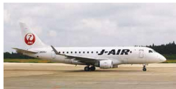
JAL【ERJ170】 全長：29.9m 全幅：26.0m 全高：9.9m 座席数：76席 主な運航路線：大阪伊丹線
