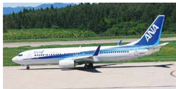
ANA【B737-800】 全長：39.5m 全幅：35.8m 全高：12.5m 座席数：166席 主な運航路線：東京羽田線
