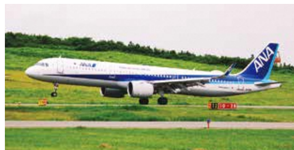
ANA【A321neo】 全長：44.5m 全幅：35.8m 全高：11.8m 座席数：194席 主な運航路線：東京羽田線
