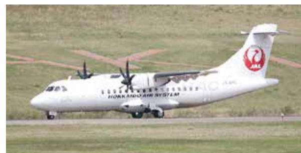
HAC【ATR-42-600】 全長：22.67m 全幅：24.57m 全高：7.59m 座席数：48席 主な運航路線：札幌丘珠線
