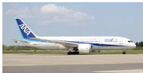
ANA【B787-8】 全長：56.69m 全幅：60.05m 全高：17.07m 座席数：335席 主な運航路線：東京羽田線
