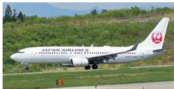
JAL【B737-800】 全長：39.5m 全幅：35.8m 全高：12.5m 座席数：165席 主な運航路線：東京羽田線
