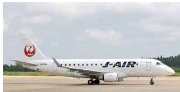
JAL【ERJ170】 全長：29.9m 全幅：26.0m 全高：9.9m 座席数：76席 主な運航路線：大阪伊丹線
