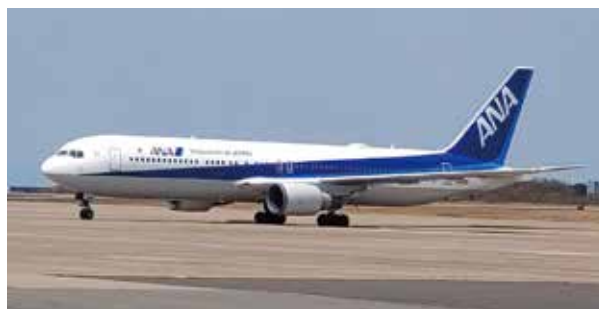
ANA【B767-300】 全長：54.94m 全幅：47.57m 全高：15.85m 座席数：270席 主な運航路線：東京羽田線
