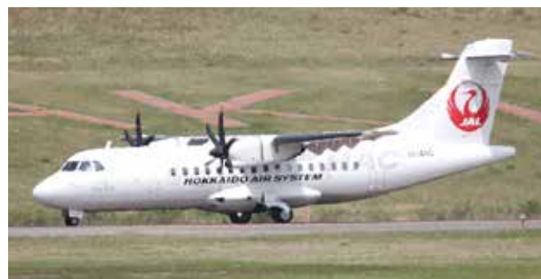
HAC【ATR-42-600】 全長：22.67m 全幅：24.57m 全高：7.59m 座席数：48席 主な運航路線：札幌丘珠線
