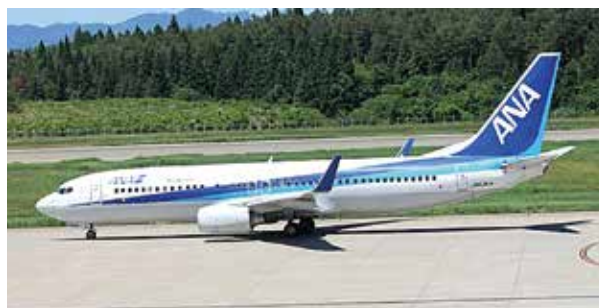
ANA【B737-800】 全長：39.5m 全幅：35.8m 全高：12.5m 座席数：166席 主な運航路線：東京羽田線
