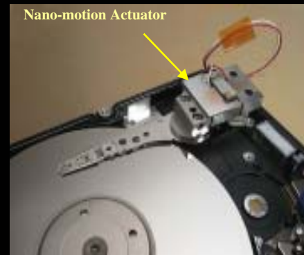
磁気記録再生試験 装置に搭載された アクチュエータ
