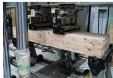
CLTの耐荷重試験
