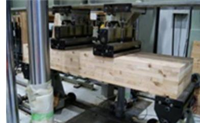
CLTの耐荷重試験
