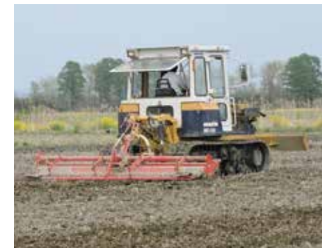
代かきせずに土を細かくする作業
