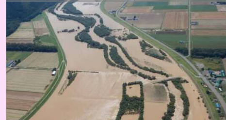
越水による堤防の法崩れ(常呂川)
