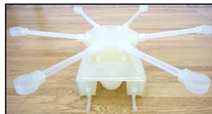
3Dプリンタで造形した1/3モックモデル
