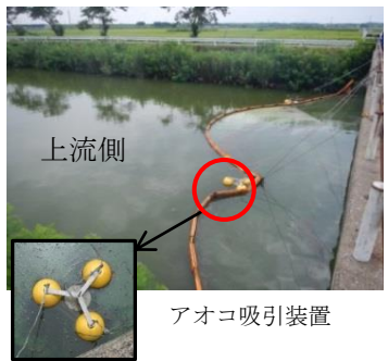
装置後方のフェンスをすり抜けたアオコを吸引
