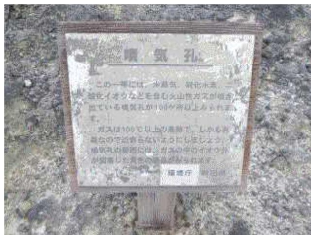
硫化水素ガス等による解説板の劣化
