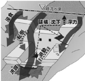
図 堰堤機能損失のイメージ
