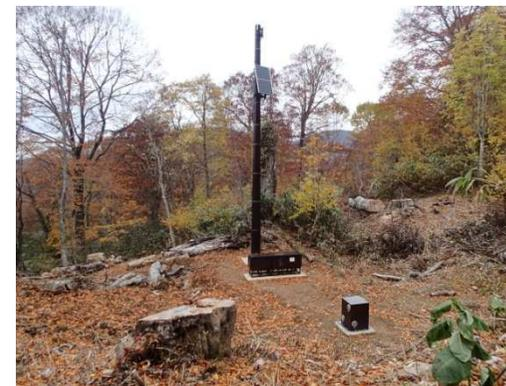
写真1 新規設置の地震計
