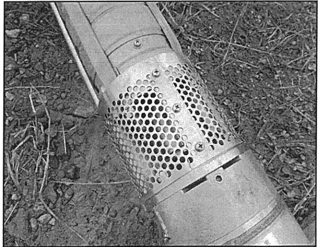
沈殿物を洗浄した後の水中ポンプ
