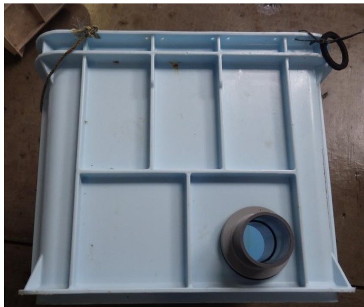
写真8 受水部排水口
