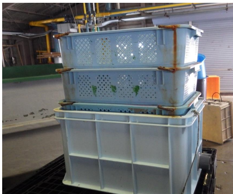
写真9 收容部と受水部の設置例
