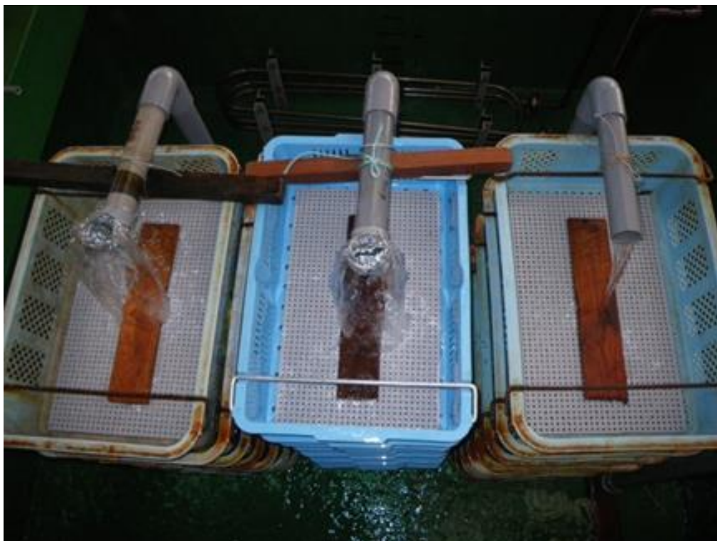
写真5 木の板と穴あきのプラスチック板で海水を分散させる
