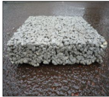
底穴用ブロック (ポーラスコンクリート製)
