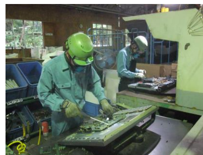
薄型テレビ解体の様子
