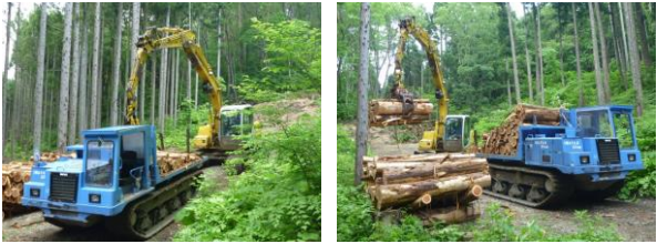
フォワーダとグラップル付きバックホウにより作業効率向上
