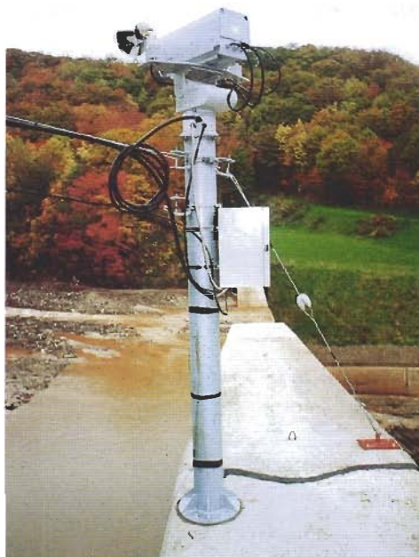
土石流などを見張る監視カメラ（赤川1号砂防ダム・鹿角市）
