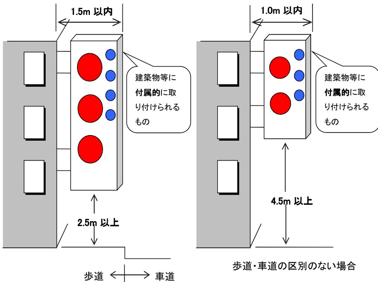
※ 発光装置・照明装置のある場合は、交通信号機から20m以内に設置できない。
