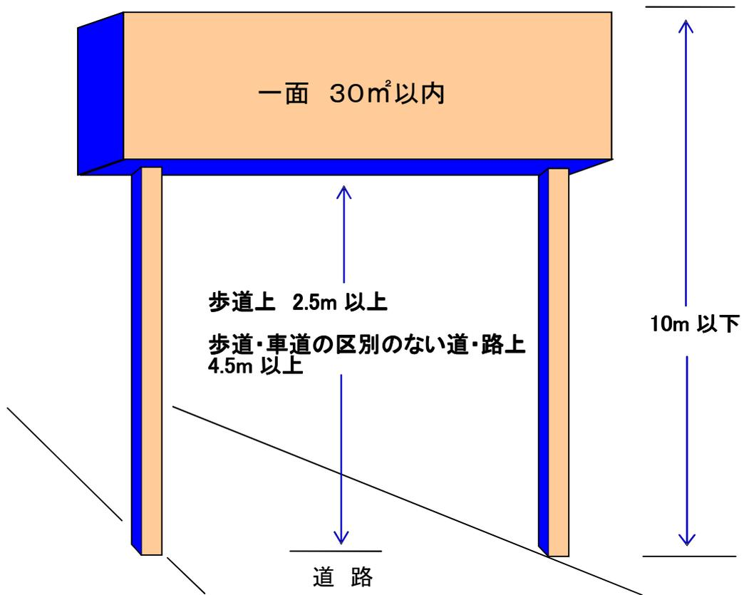
※ 発光装置・照明装置のある場合は、交通信号機から20m以内に設置できない。
